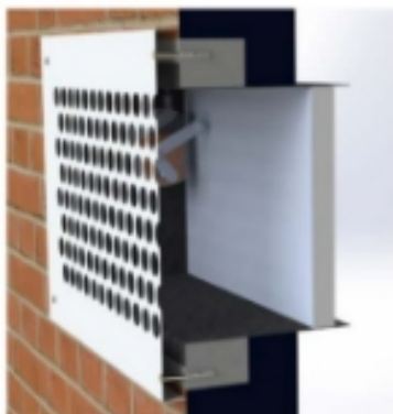
Монтаж решетки РЭД-РКДМ(ОР)
