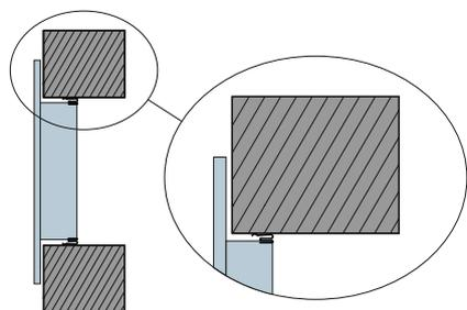
**Монтаж с монтажной рамкой (РЭД-РМУ) на защелке (РЭД-Клипс)**
